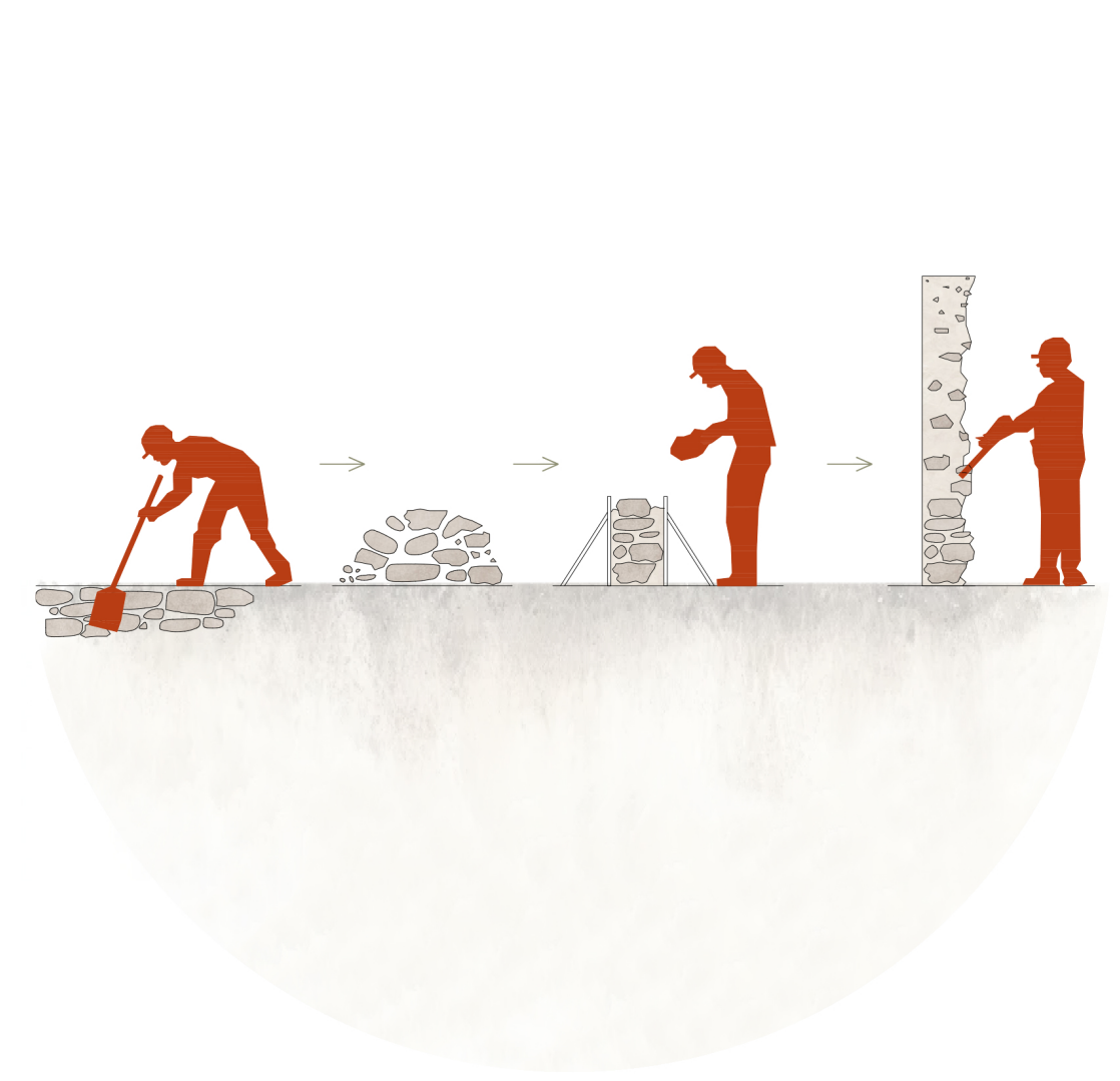
Dobivanje agregata za nove betonske zidove iz iskopa
